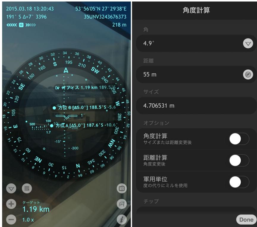
同様に物体の左端と右端をマークし、方位角を使って計算することによって、物体の幅を知ることが可能です。同様に左下と右上のポイントを、球体角を使って計算することによって、物体の対角線の長さを知ることが可能です。
